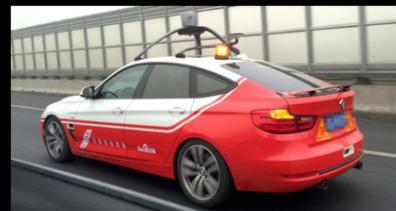
百度无人驾驶车项目于 2013 年起步，由百度研究院主导研发，其技术核心是“百度汽车大脑”，包括高精度地图、定位、感知、智能决策与控制四大模块。百度自主采集和制作的高精度地图记录完整的三维道路信息，能在厘米级精度实现车辆定位。同时，百度无人驾驶车依托国际领先的交通场景物体识别技术和环境感知技术，实现高精度车辆探测识别、跟踪、距离和速度估计、路面分割、车道线检测，为自动驾驶的智能决策提供依据。如果还有说还有哪家科技巨头正在无人驾驶汽车领域挑战谷歌，那肯定非百度莫属。
